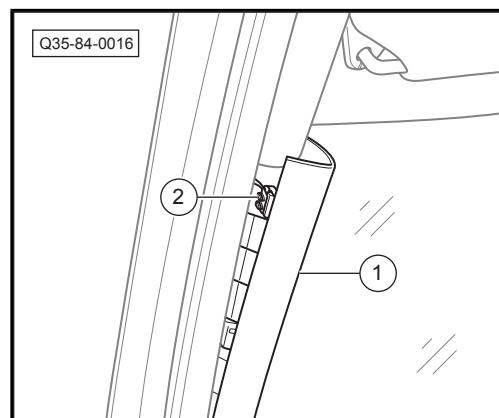
5. 断开左侧A柱高音扬声器连接插头-箭头-, 取下左侧A柱上饰板。
