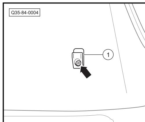
11. 旋出固定螺钉-箭头-, 取下右侧遮阳板总成支座-1-。
