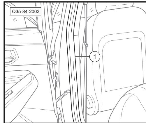
6. 从-箭头-位置脱开左侧B柱下饰板-1-与左侧B柱上饰板-2-的连接，取下左侧B柱下饰板-1-。
