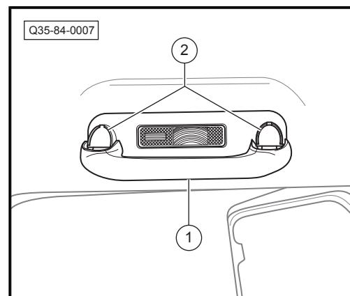
15. 旋出后乘客左侧扶手总成固定螺钉-箭头-, 脱开后乘客左侧扶手总成-1-。
