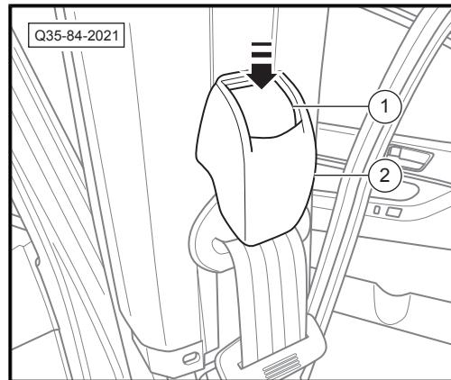
5. 旋出左前预张紧安全带上端固定螺栓-箭头-, 移开安全带-1-。
