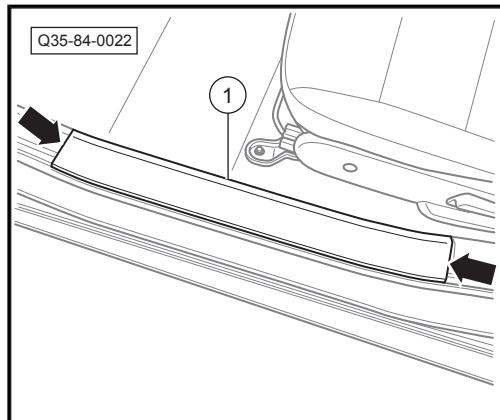
2. 脱开左前门框密封条-1-盖住左侧A柱下饰板部分。
