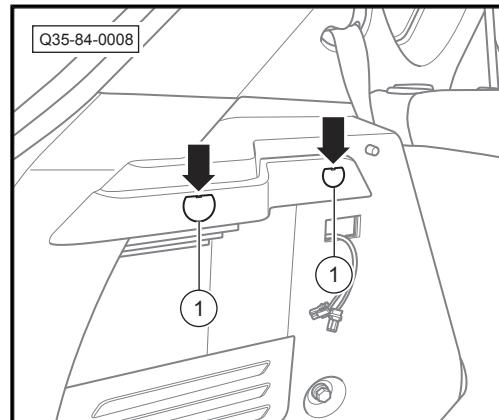
10. 旋出左侧轮罩饰板固定螺钉-箭头-, 脱开左侧轮罩饰板总成-1-与左侧C柱饰板总成-2-的连接, 拆下左侧轮罩饰板总成-1-。
