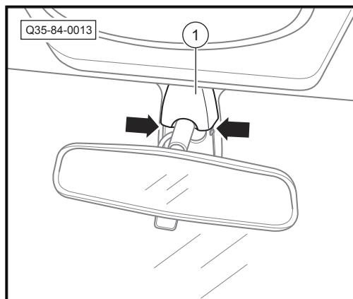
4. 旋松固定螺钉-箭头A-, 沿-箭头B-方向取出后视镜-1-。
