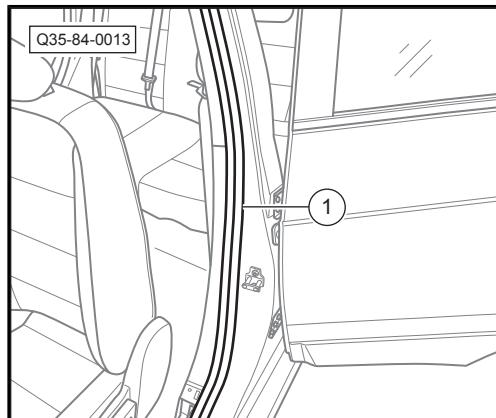
5. 脱开左后门框密封条-1-盖住左侧B柱下饰板的部分。
