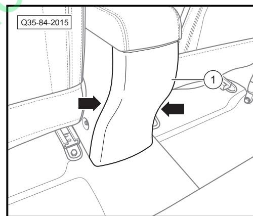
10. 旋出副仪表板骨架组件固定螺栓-箭头-。
