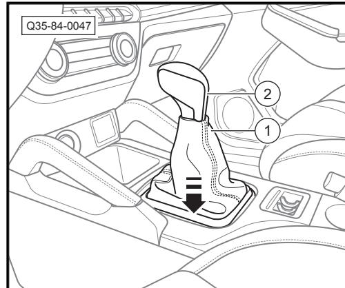
7. 从-箭头-位置向脱开固定卡，拆下换档操纵球头-1-。
