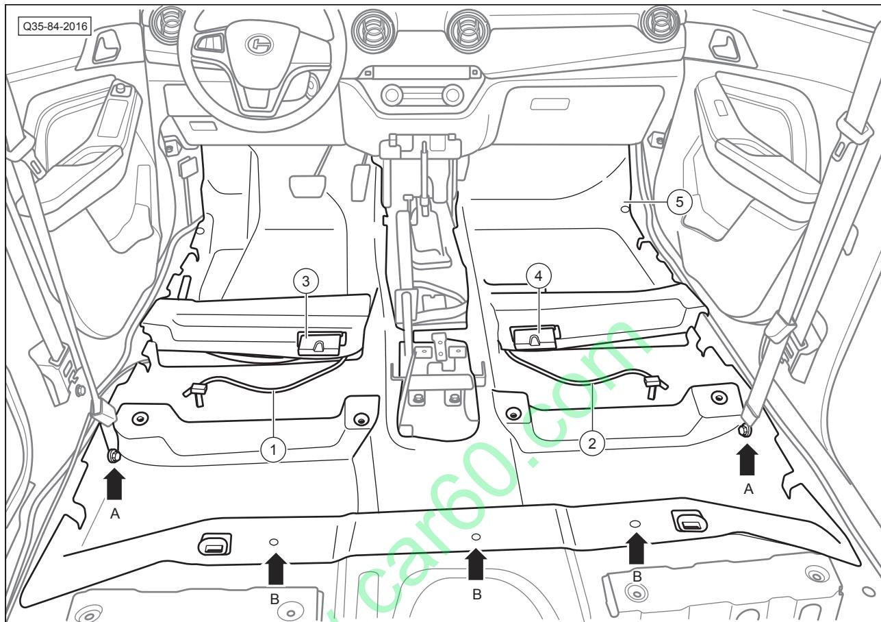
6. 旋出安全带总成固定螺栓-箭头A-, 将线束-1和-2从地毯中抽出，脱开地毯总成与后排吹脚导风管总成-3和-4的连接，脱开固定卡口-箭头B-, 取出地毯总成-5。
